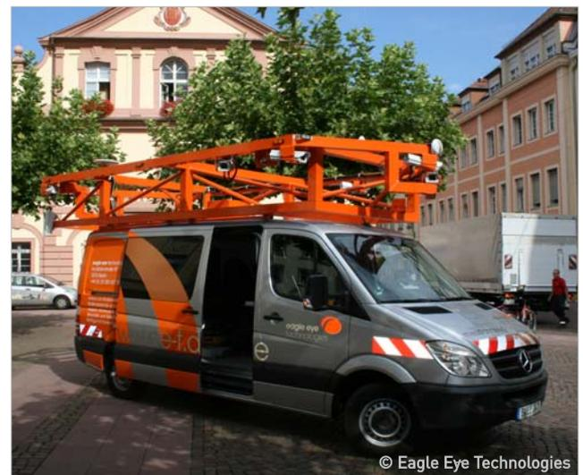
Die Fahrzeuge der Firma eagle eye technologies sind mit speziellen Sensoren ausgestattet, mit deren Hilfe die Straßenflächen während der Befahrung vermessen wurden. Georeferenzierte Bilder der Fahrbahnen – aufgenommen mit zehn Präzisionskameras am Messfahrzeug – lieferten die Detailinformationen zum Straßenzustand. Dank der hochgenauen Navigations-sensorik ist im städtischen Umfeld flächendeckend eine Lagegenauigkeit zu erreichen, die sonst nur mit hohem nachträglichem Aufwand herzustellen ist.
