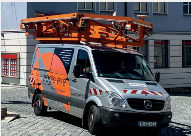
eagle eye technologies Messfahrzeug bei der Datenerfassung © eagle eye technologies
